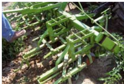
Fig. 3.21. Sarchiatrice di precisione con quattro elementi sarchianti durante un intervento su cavolfiore presso l'azienda Grossi (Comune di Vecchiano).
