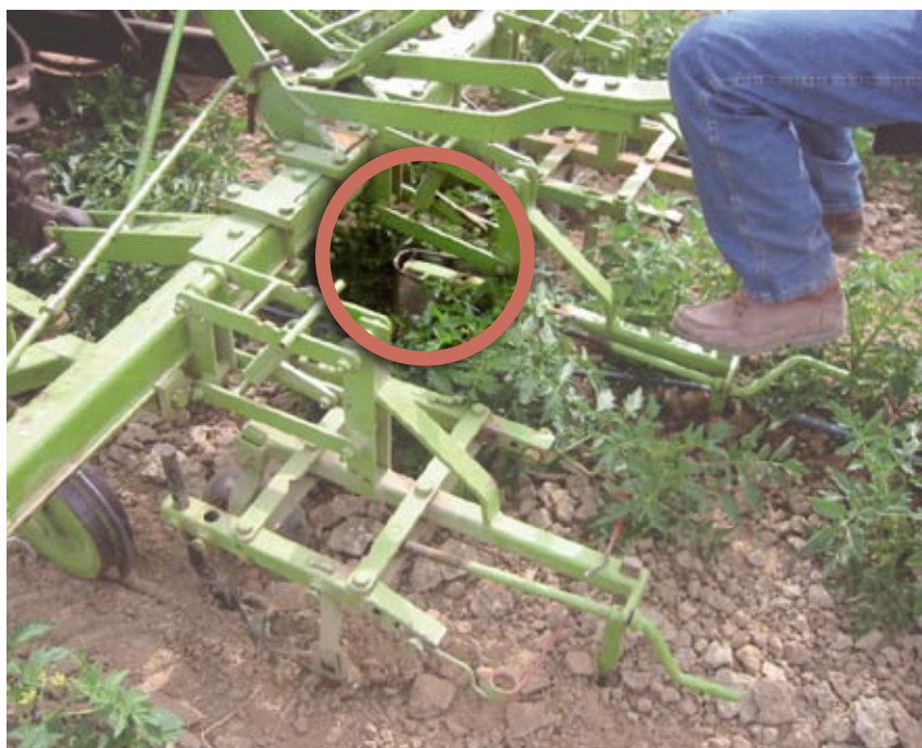
Fig. 3.26. Supporto a "V" (visibile nel centro della foto), implementato sulla sarchiatrice di precisione, al fine di aprire delicatamente la vegetazione, durante l'intervento tardivo su pomodoro coltivato a file binate presso l'azienda Catassi (Comune di San Giuliano Terme).
