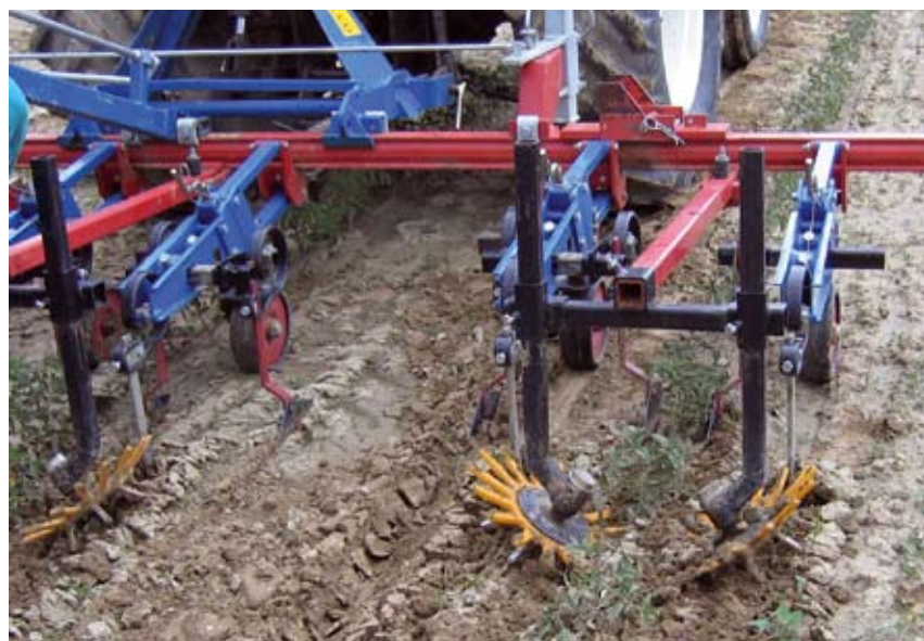
Fig. 2.29. Finger weeder della ditta tedesca Kress in fase di lavoro sulla fila di una coltura di pomodoro.
