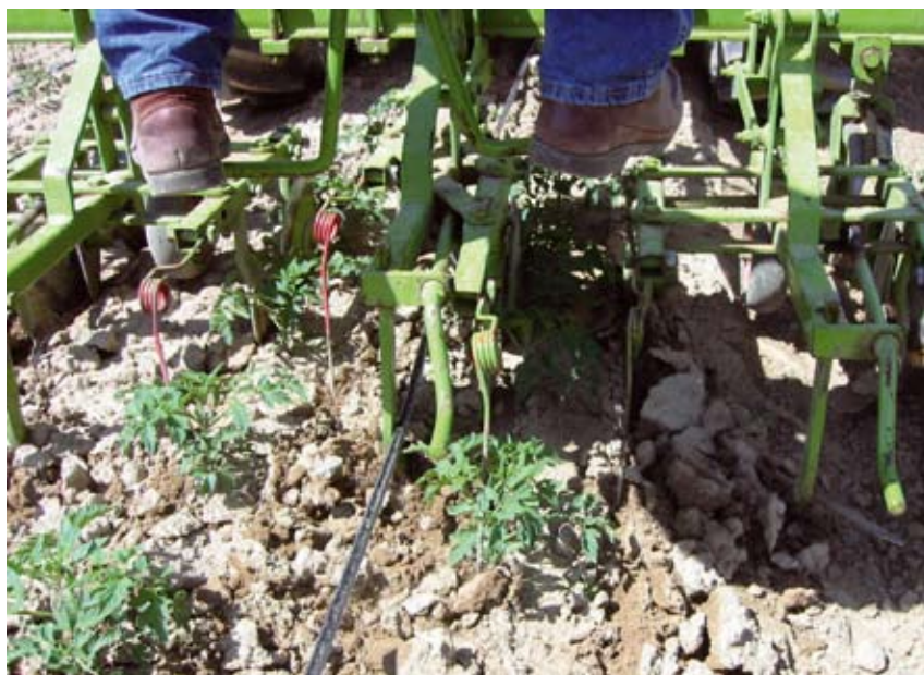
Fig. 3.25. Particolare dell'elemento centrale della sarchiatrice di precisione che opera sotto la manichetta di irrigazione su pomodoro coltivato a file binate presso l'azienda Catassi (Comune di San Giuliano Terme).
