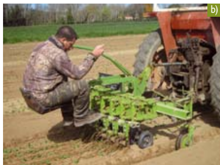
Fig. 2.27. Sarchiatrice di precisione dotata di sistema di guida manuale e di utensili elastici per il controllo selettivo delle infestanti sulla fila sviluppate dall'Università di Pisa: a) operatrice per interfila compresi tra 30 e 90 cm; b) operatrice per interfila compresi tra 18 e 30 cm.
