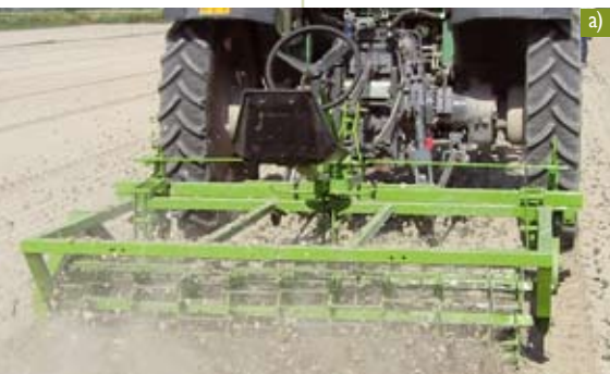
Fig. 3.9. Versione perfezionata dell’erpice a dischi attivi, caratterizzata da un fronte di lavoro pari a 2 m, durante un intervento di falsa semina (a) e di sarchiatura su cavolo (b) verza presso l’azienda Catassi (Comune di San Giuliano Terme).
