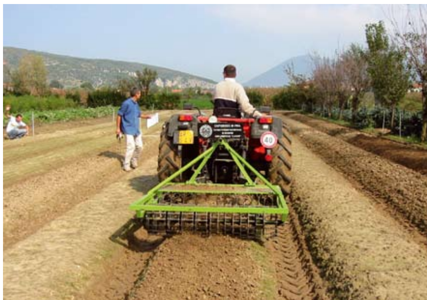
Fig. 3.7. Erpice a dischi attivi da 1,4 m di fronte di lavoro in fase operativa durante un intervento di falsa semina su spinacio nella Valle del Serchio.
