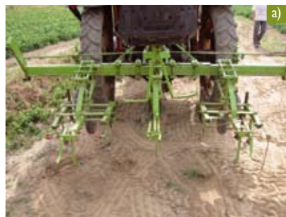
Fig. 3.24. Sarchiatrice di precisione con tre elementi sarchianti impiegata su pomodoro a file binate coltivato secondo il sistema innovativo presso l'azienda Catassi (Comune di San Giuliano Terme): operatrice sollevata (a) ed in fase operativa (b).
