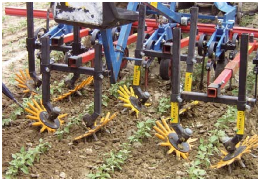
Fig. 2.28. Finger weeder della ditta tedesca Kress combinato con sarchiatrice equipaggiata con utensili rigidi in fase di lavoro su soia.
