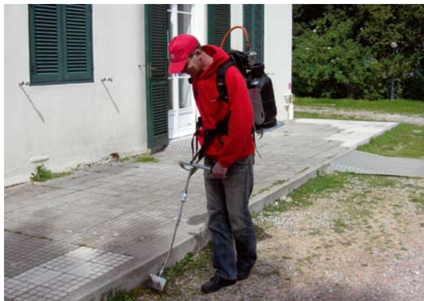
Fig. 2.25. Macchina spallaggiata per il pirodiserbo della ditta MAITO, utilizzabile su piccole superfici in contesti sia urbani che agricoli
