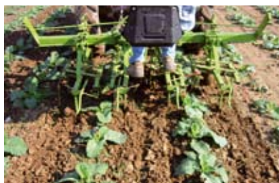
Fig. 3.22. Sarchiatrice di precisione con quattro elementi sarchianti durante un intervento su cavolo verza presso l'azienda Catassi (Comune di San Giuliano Terme).
