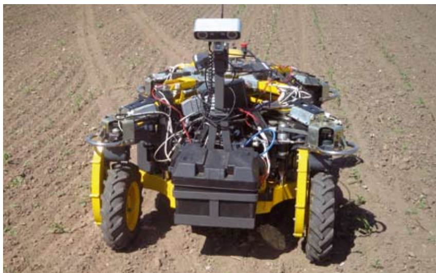
Fig. 2.31. "Hortibot", robot sviluppato dall'Università di Aarhus (DK) per la "cura hi-tech" delle specie orticole (Nørre-mark et al. , 2006).
