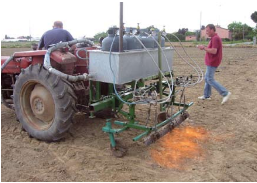
Fig. 3.8. Operatrice portata per il pirodiserbo impiegata per gli interventi di controllo fisico delle erbe infestanti su pomodoro coltivato secondo la tecnica alternativa nei Comuni di San Giuliano Terme e di Vecchiano durante l'attività sperimentale del 2006.
