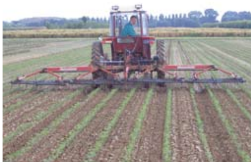
Fig. 2.20. Erpice a dischi attivi, operatrice messa a punto dall'Università di Pisa, in fase di lavoro durante un intervento di falsa semina presso il Centro Interdipartimentale di Ricerche Agro-Ambientali dell'Università di Pisa.
