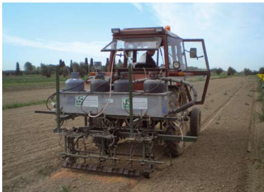
Fig.3.18. Operatrice per il pirodiserbo al lavoro prima dell'impianto del cavolfiore, nel Comune di San Giuliano Terme, nella stagione 2008-2009.
