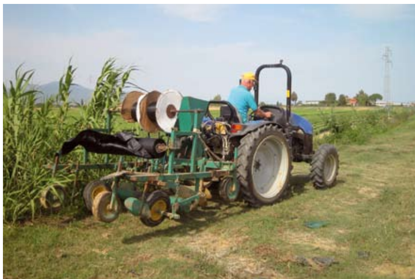
Fig.3.62. Pacciamatrice-aiuolatrice utilizzata per la stesura del bio-telo, nel sistema colturale aziendale, prima dell'impianto del cavolo.
