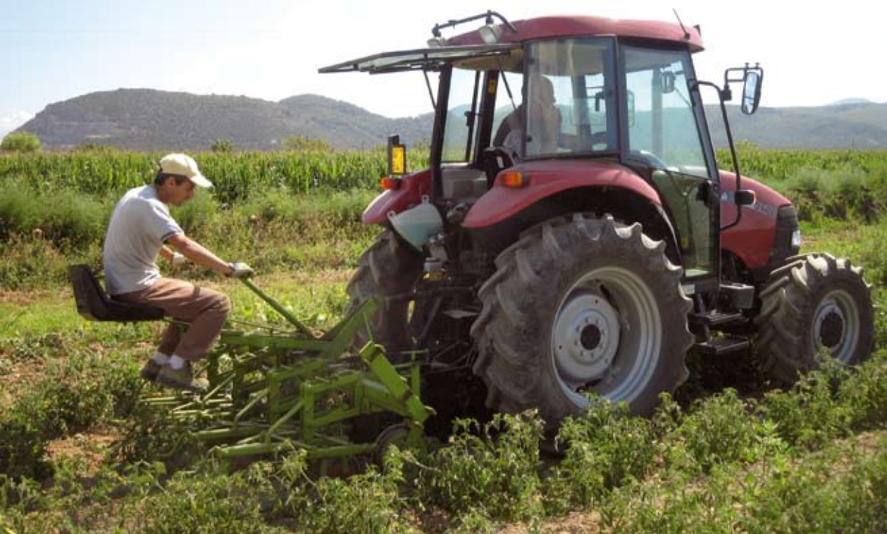
Fig. 3.49. Intervento di sarchiatura realizzato con operatrice di precisione su pomodoro da consumo fresco nel Comune di Vecchiano.
