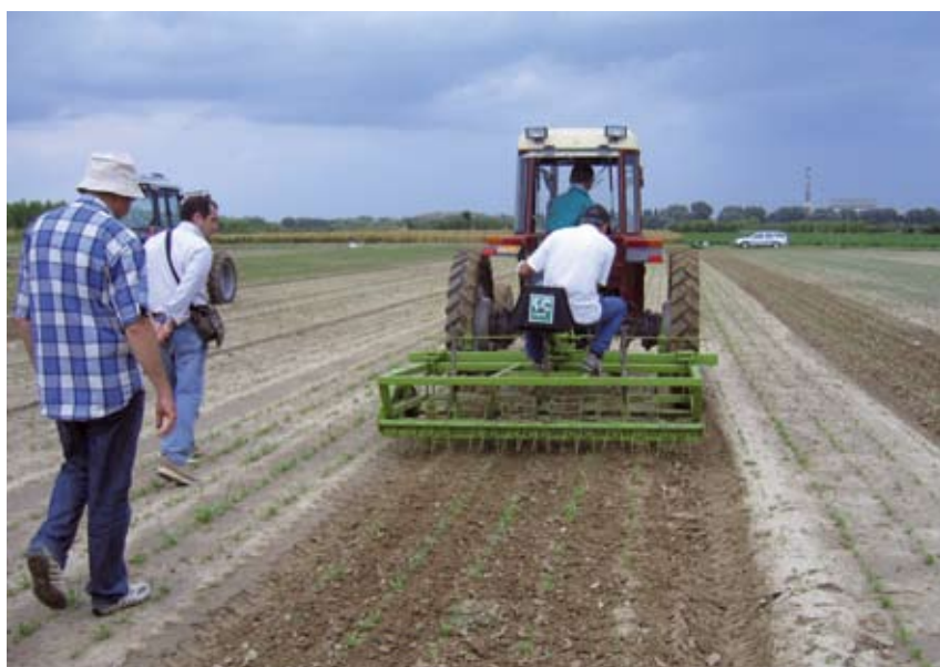
Fig. 2.26. Erpice a dischi attivi realizzato e brevettato dal Centro Interdipartimentale di Ricerche Agro-Ambientali “Enrico Avanzi” dell'Università di Pisa in fase di sarchiatura precoce su spinacio.
