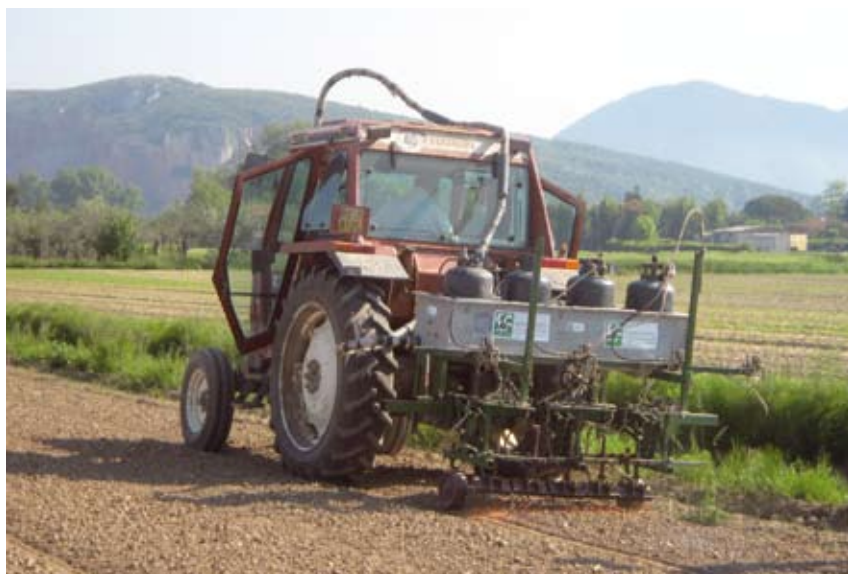
Fig. 3.17. Operatrice per il pirodiserbo al lavoro prima dell'impianto del pomodoro, nel Comune di San Giuliano Terme, nella stagione 2008-2009.
