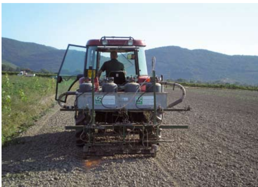
Fig. 3.16. Operatrice per il pirodiserbo al lavoro prima dell'impianto del cavolfiore, nel Comune di Vecchiano, nella stagione 2008-2009.
