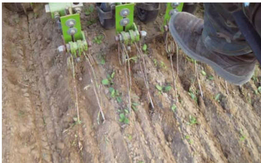
Fig. 2.30. Dettaglio dei torsion weeder e dei denti vibranti in fase di lavoro su spinacio, montati contemporaneamente su una sarchiatrice messa a punto dall'Università di Pisa.
