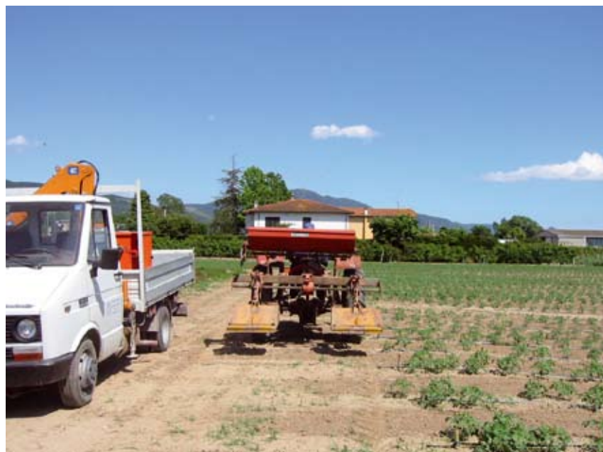
Fig. 3.30. Sarchiatrice ad utensili azionati su asse orizzontale ("multifresa") impiegata per gli interventi di post-trapianto su pomodoro coltivato secondo il sistema convenzionale presso l'azienda "Catassi" (San Giuliano Terme).
