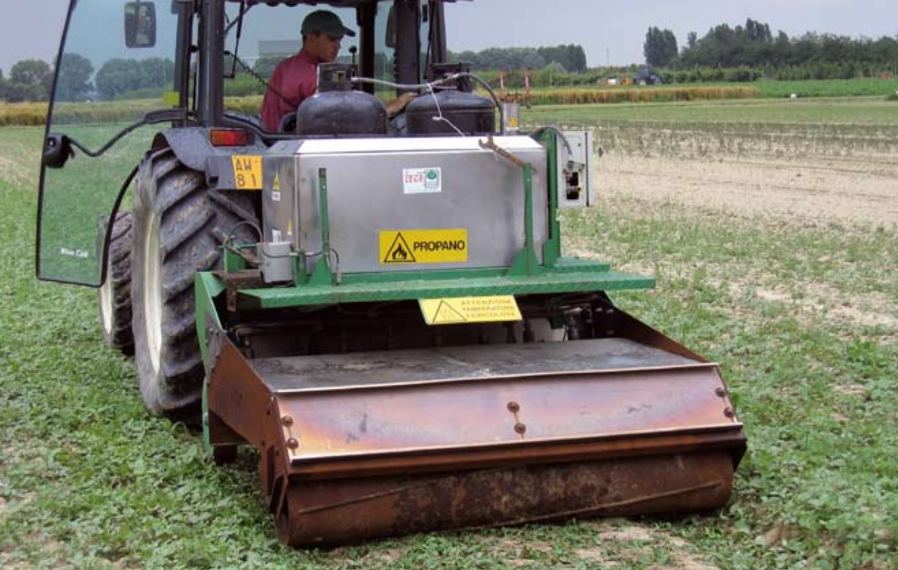
Fig. 2.24. Macchina per il pirodiserbo della ditta Mingozzi in fase di lavoro.
