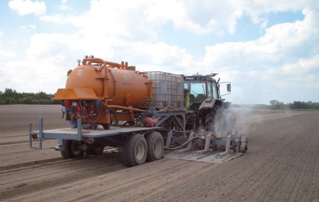
Fig. 2.23. Operatrice per trattamenti termici “in banda”, mediante uso del vapore, in fase di lavoro prima dell’impianto di carota presso un’azienda biologica in Danimarca.
