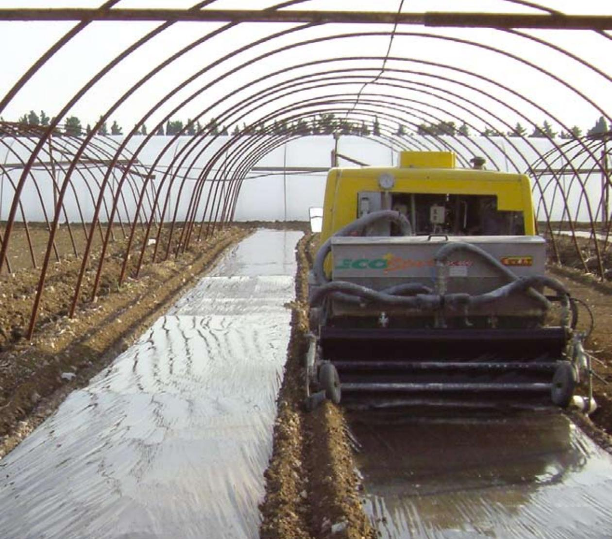
**Fig. 14** Anno 2004. Disinfezione del terreno in spazi molto ristretti, sotto tunnel, a Ragusa con l'operatrice Ecostar SC 600 della Celli.
