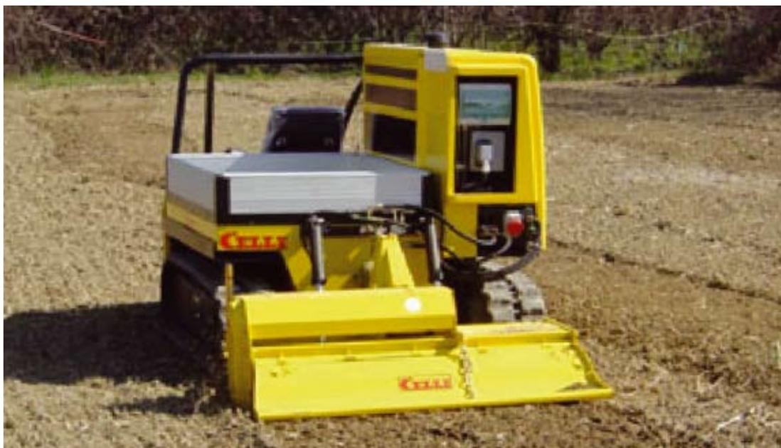
**Fig. 6** *L'operatrice semovente cingolata equipaggiata con cassone di carico ed accoppiata a zappatrice rotante.*
