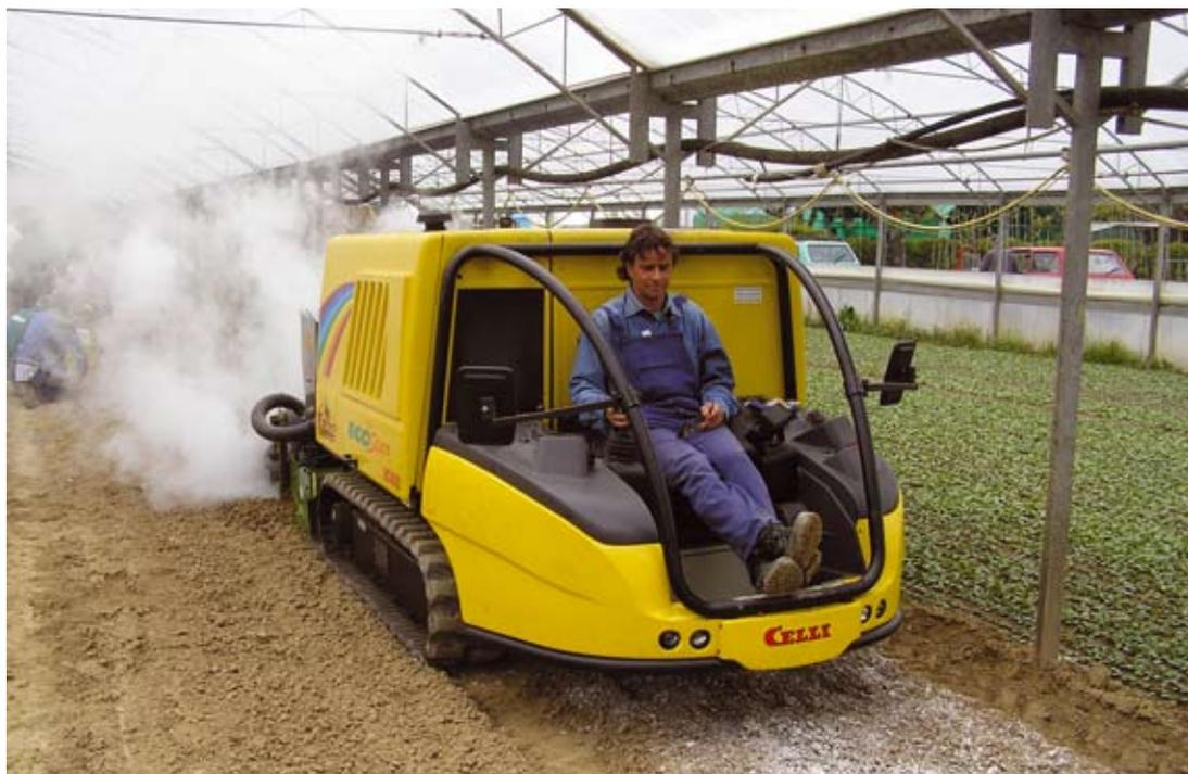
**Fig. 1** Disinfezione del terreno con vapore e sostanze a reazione esotermica realizzata con la macchina semovente "Ecostar SC 600" della Ditta Celli.
