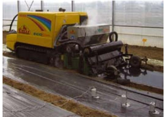
**Fig. 10** Operatrice semovente cingolata Celli Ecostar SC 600 e misura delle temperature durante le prove sperimentali.
