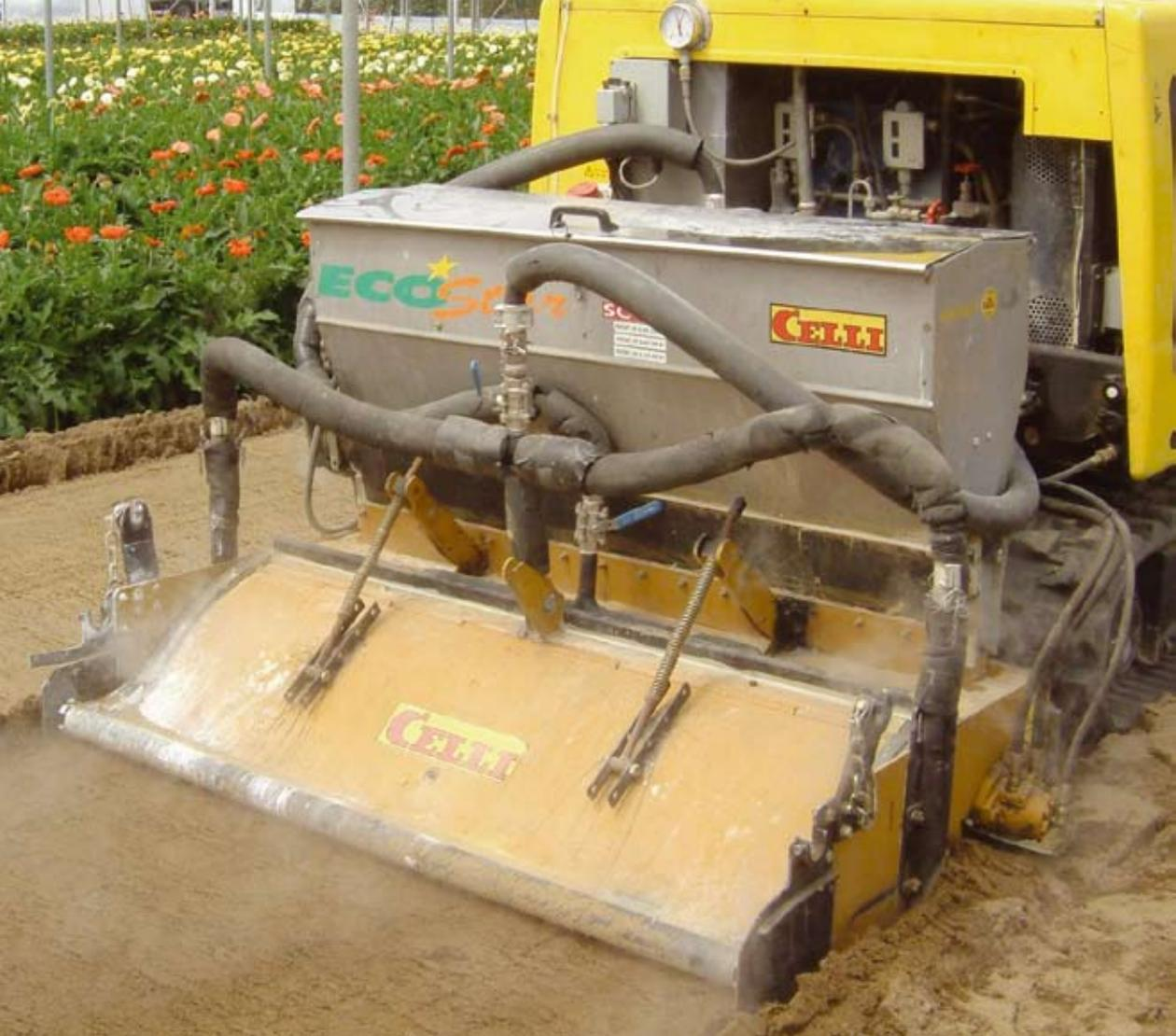
**Fig. 13** Anno 2004. Disinfezione del terreno in serra a Vibo Valentia con l'operatrice Ecostar SC 600 della Celli.
