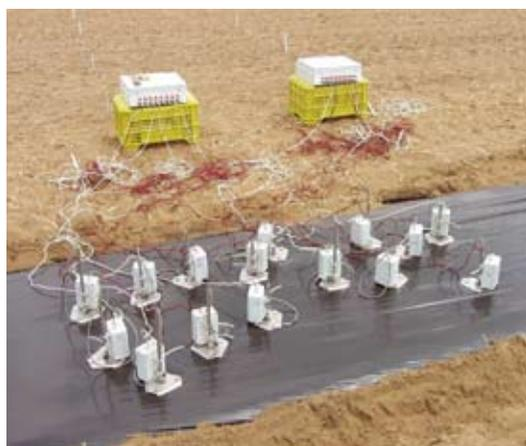
**Fig. 4** Sonde PT100 connesse ad appositi data loggers, durante la registrazione della temperatura del terreno a seguito di un trattamento di disinfezione.
