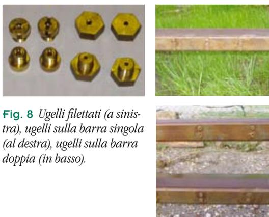
**Fig. 8** Ugelli filettati (a sinistra), ugelli sulla barra singola (al destra), ugelli sulla barra doppia (in basso).
