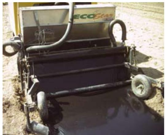
**Fig. 3** Particolare della aiuolatrice-pacciamatrice, inserita nella parte posteriore della macchina semovente per la disinfezione del terreno Celli "Ecostar SC600".
