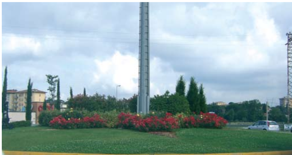
Fig.1. Signa (FI) - il prato che arriva al perimetro esterno e l'assenza di banchina rendono l'irrigazione di questa rotonda estremamente difficoltosa.
