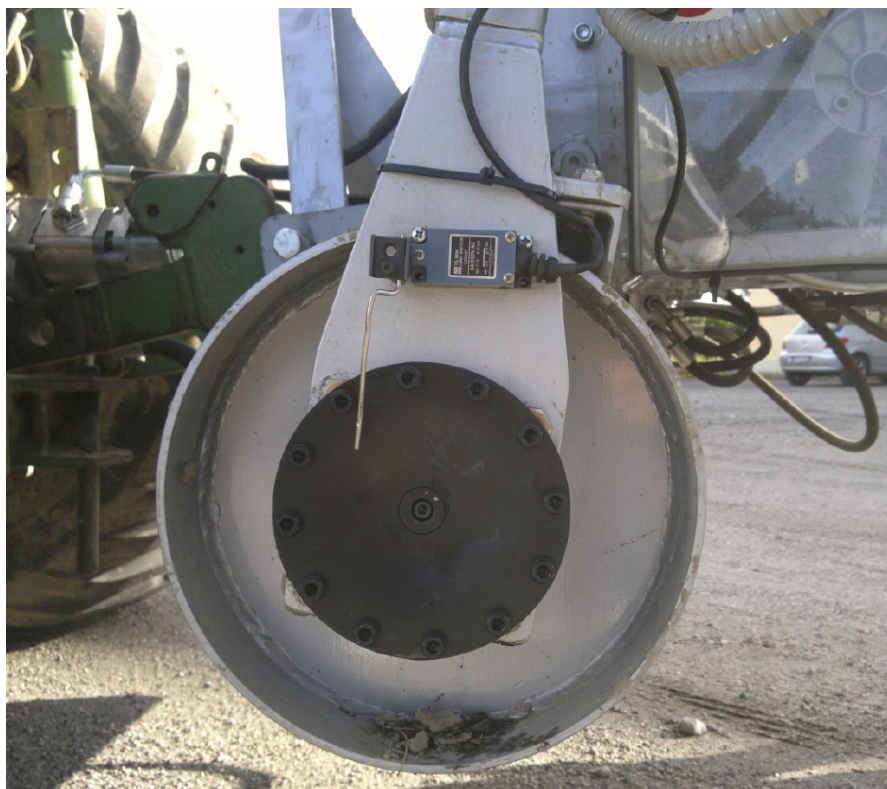
Figura 9 – Rullo metallico anteriore della trapiantatrice provvisto del dispositivo per il rilevamento della velocità di avanzamento.
