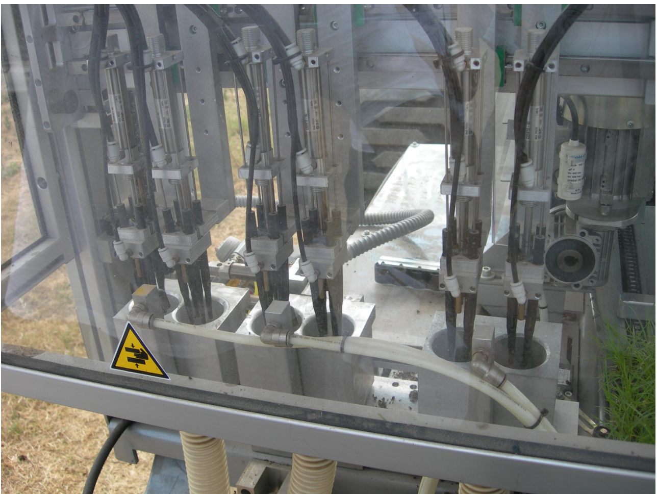
Figura 10 – Particolare del sistema di estrazione e prelievamento delle piantine. Tutti i cinematismi devono essere lubrificati periodicamente per un corretto funzionamento della trapiantatrice.
