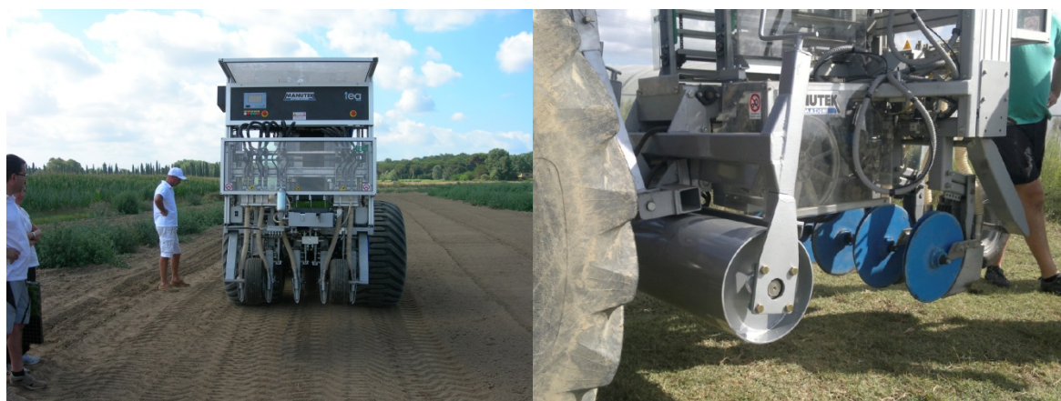
Figura 4 – Prototipo di trapiantatrice automatica per essenze da tappeto erboso allevate in vassoi alveolati
