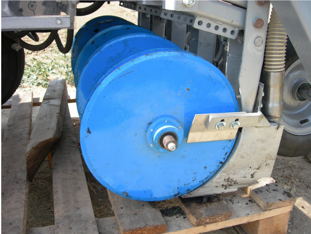
Figura 7 – Assolcatore provvisto di dischi inclinati
